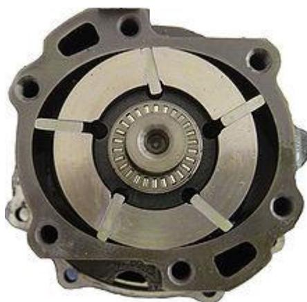
Рисунок 8. Пластинчатый насос
