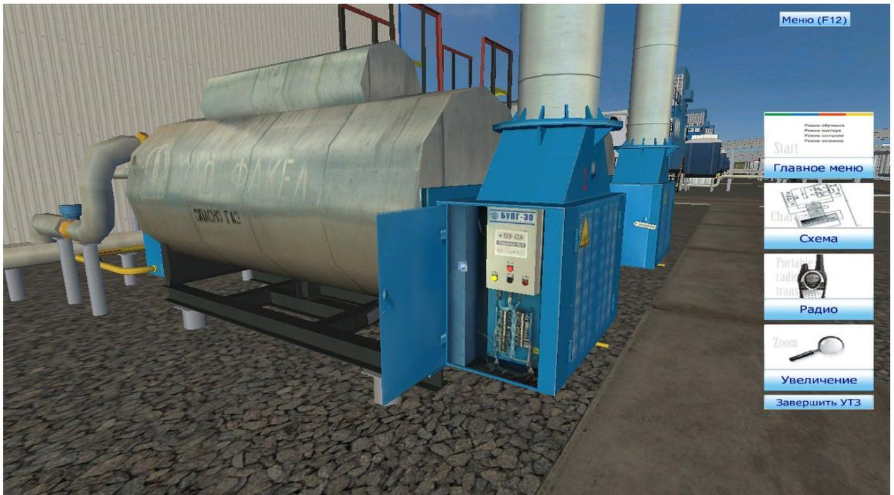
Рисунок 1.5.1. Подогреватель топливного газа №1
