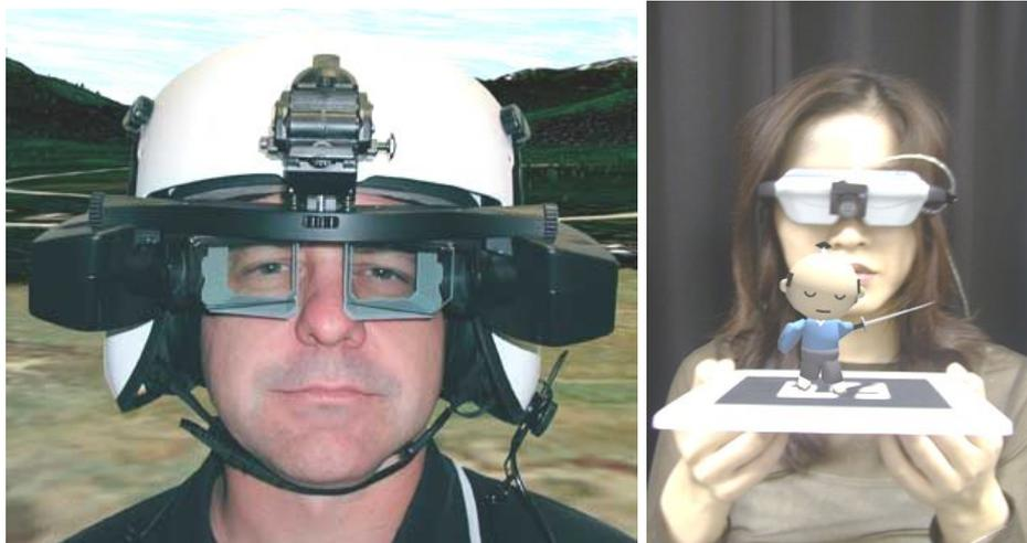
Рисунок 4.5.36. Система Rockwell Collins Sim Eye SR100 и использование камеры
