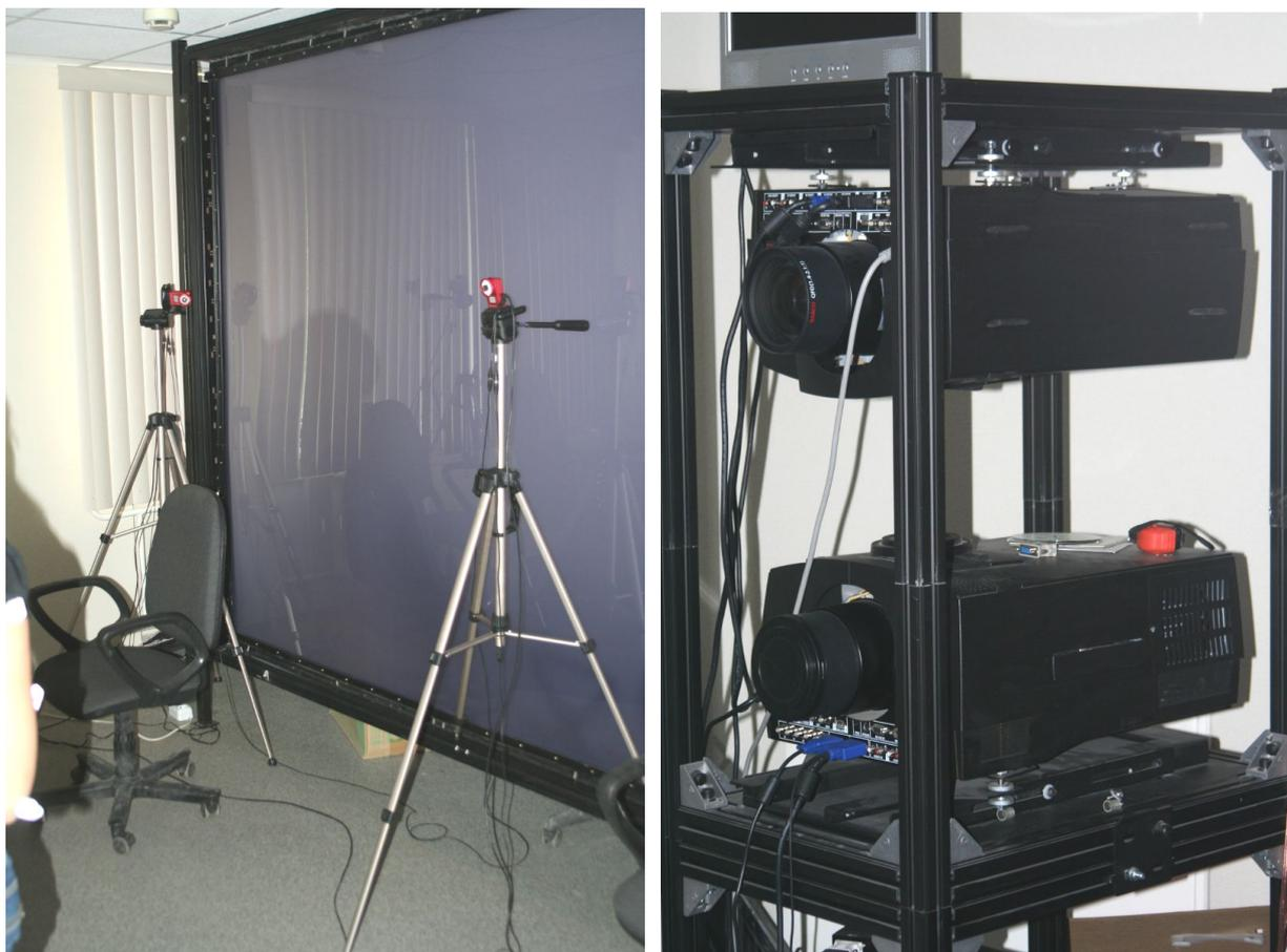
Рисунок 4.5.17. Внешний вид стойки проекторов (фильтры в объективе) и экрана обратной проекции
