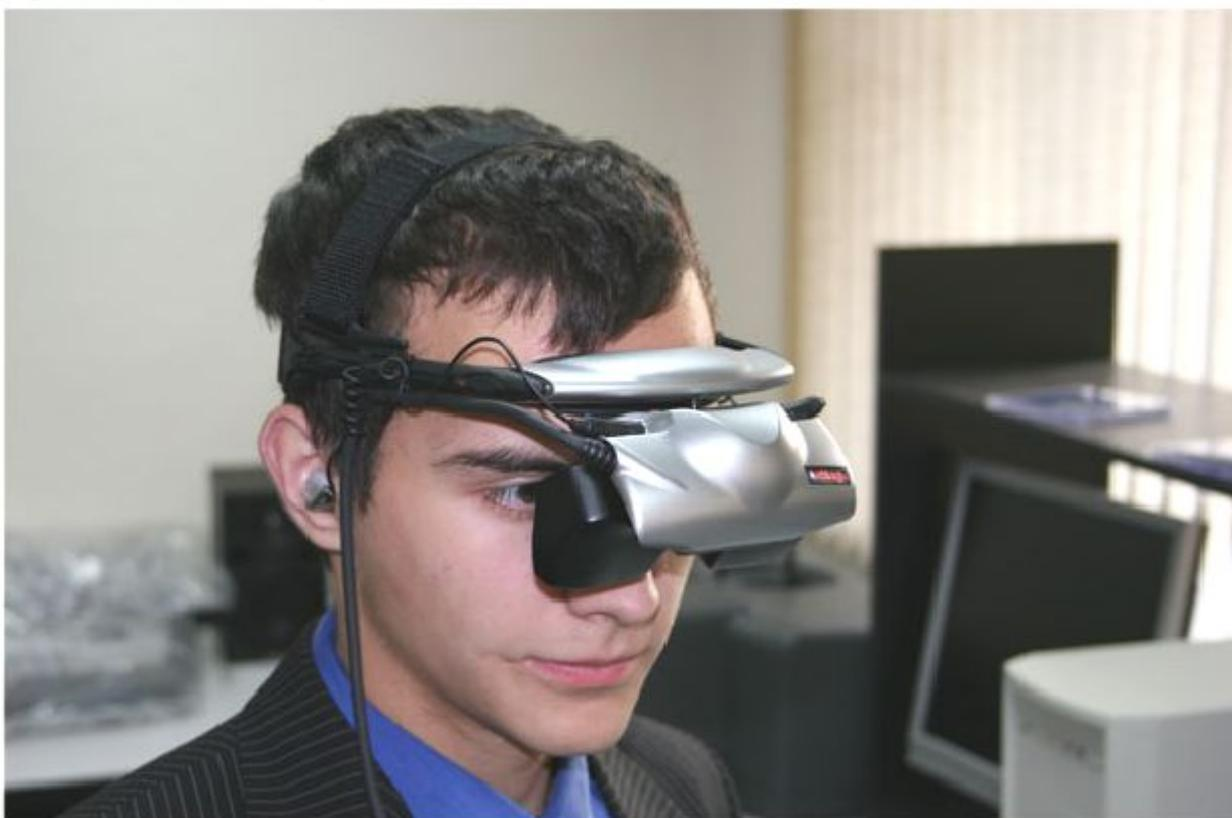
Рисунок 4.5.13. Шлем VR eMagin Z800 3D Visor
