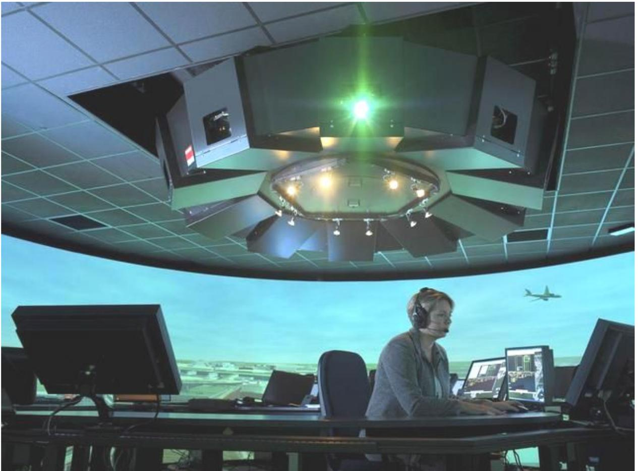
Рисунок 4.5.18. Панорамные системы визуализации на примере тренажера диспетчера аэропорта (projector system by Mersive [117])
