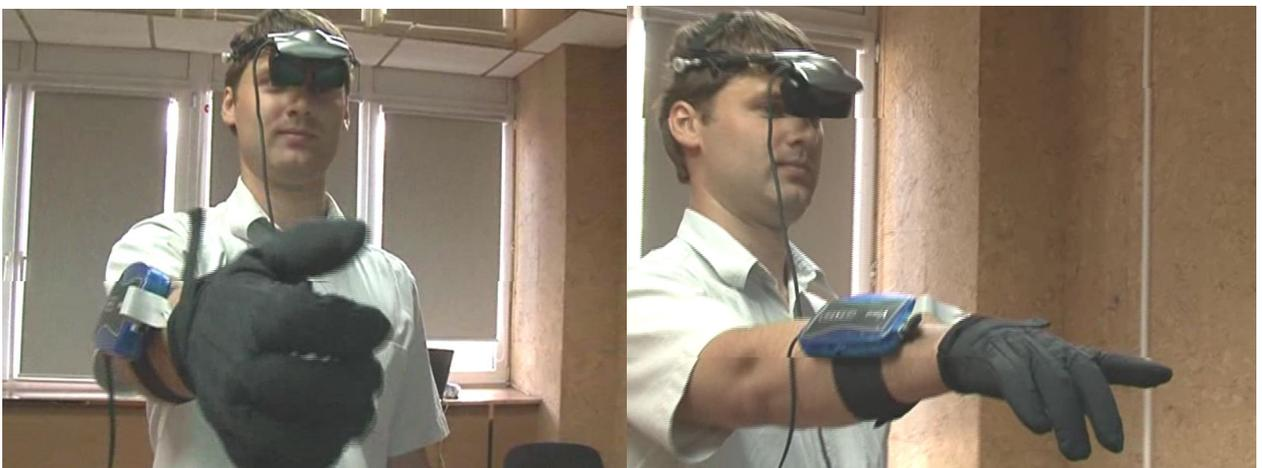
Рисунок 4.5.37. «Классическое» проводное подключение (видео, аудио сигнал, перчатка) ограничивает перемещения в пределах 1,5 метров.
