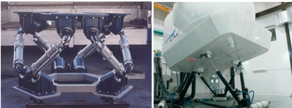
Рисунок 4.5.31. Силовая платформа и авиационный тренажер на платформе
