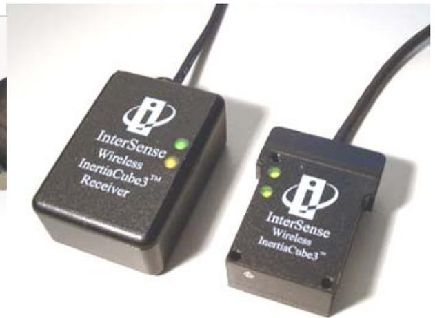
Рисунок 4.5.28. Инерциальные системы захвата движения - Intersense InertiaCube
