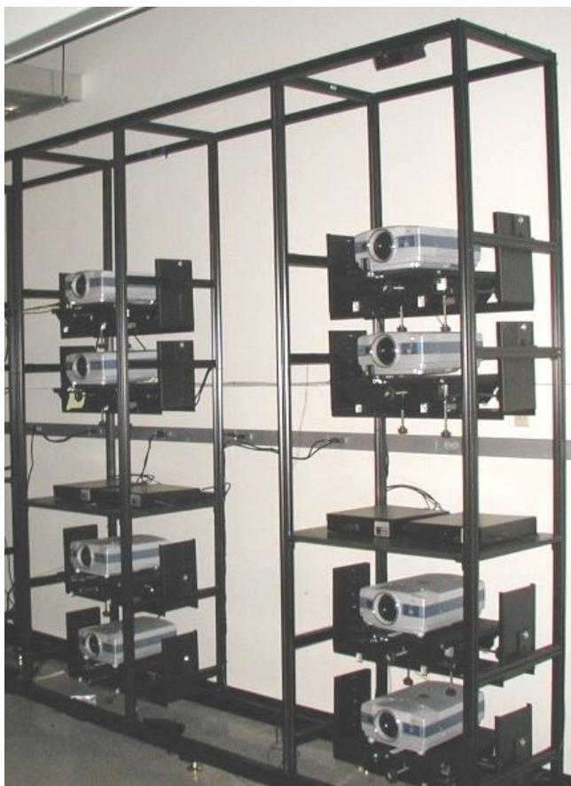
Рисунок 4.2.26. «стена» из проекторов (VR wall)
