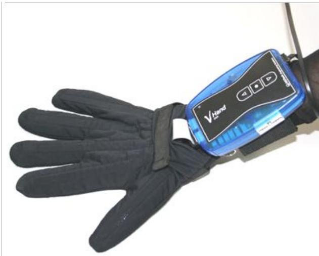
Рисунок 4.5.27. Механические системы захвата движения - перчатка системы VR
