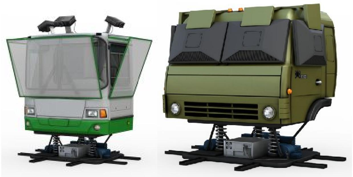
Рисунок 4.2.25. Варианты использования нескольких проекторов и мониторов в существующих атотренажерах
