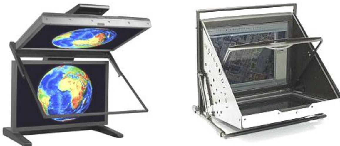
Рисунок 4.5.22. Расположение мониторов спереди и сверху (Planar), монитор располагается снизу (StereoPixel)
