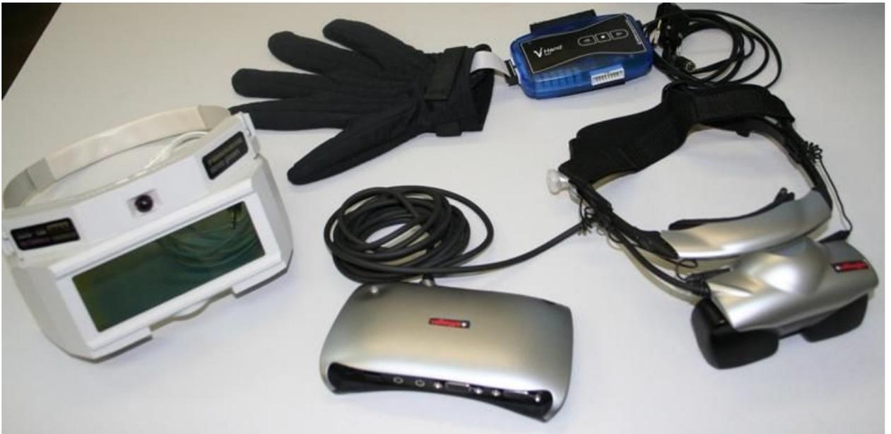
Рисунок 3.4.4. Пример использования устройств ввода системы формирования виртуальной реальности - (перчатка и шлем).
