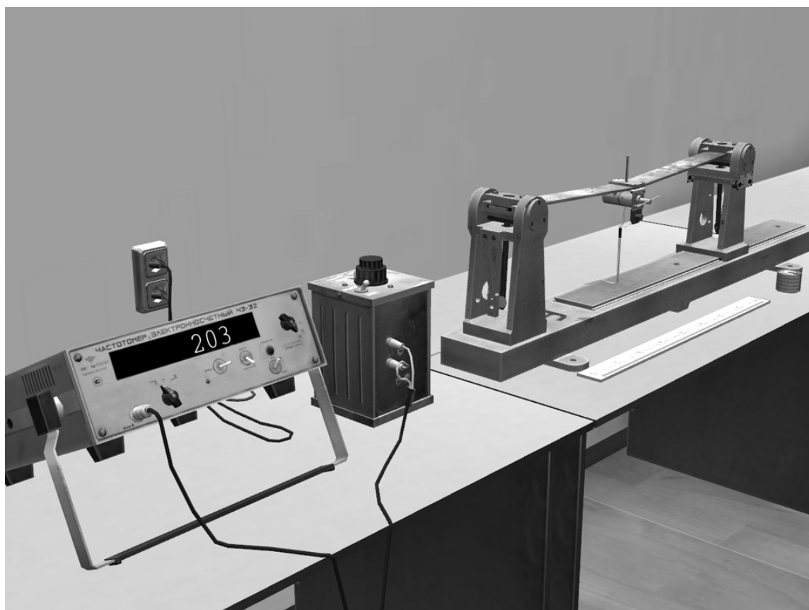
КИТ “Изучение резонансных явлений при упругих колебаниях”
