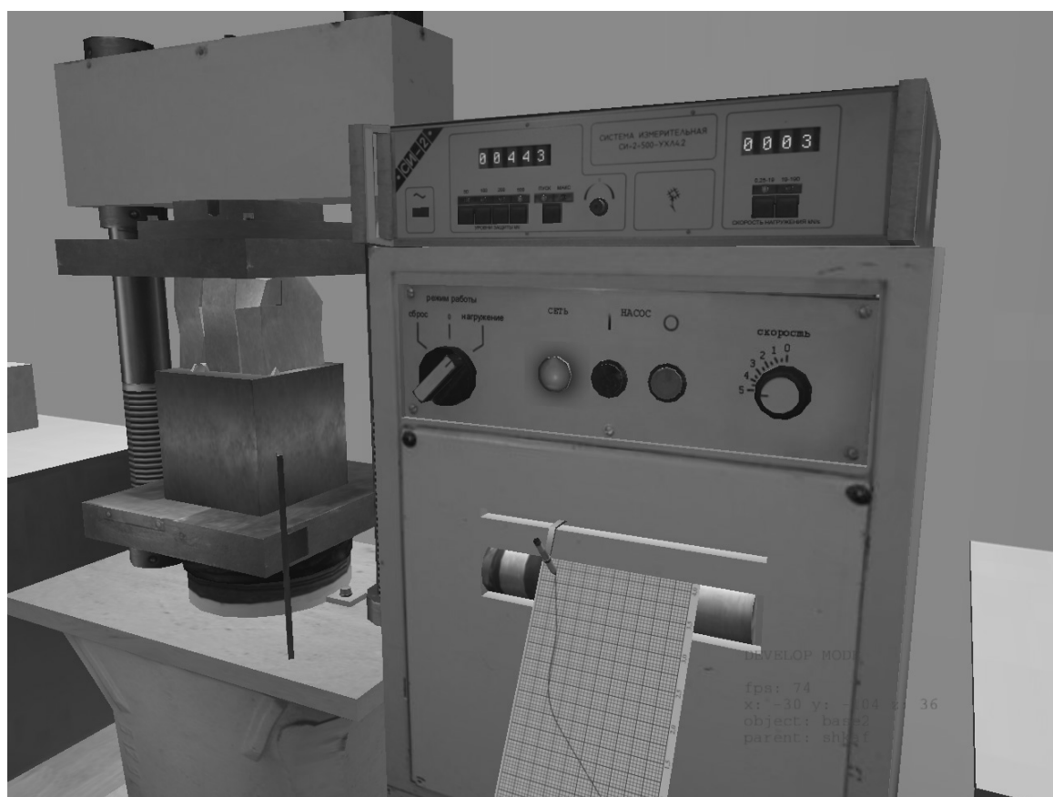
КИТ “Испытание материалов на сжатие”
