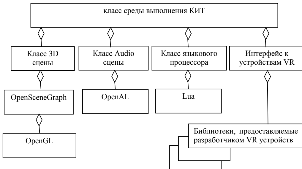
Рисунок 2.21. UML-схема модуля просмотра и отладки
